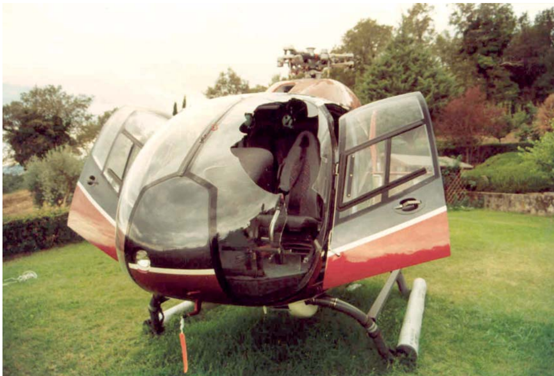
Danneggiamento del plexiglass dell'elicottero lato sinistro.
