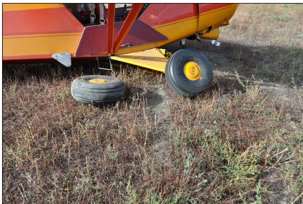
Foto 3: particolare dei danni al carrello.
