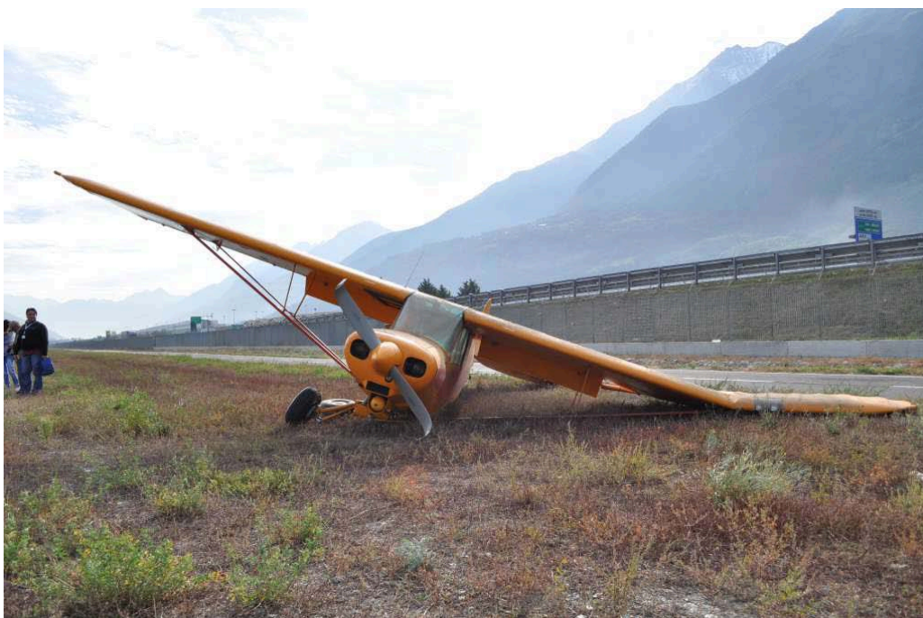
Foto 2: particolare dei danni all'elica e alla semiala sinistra.
