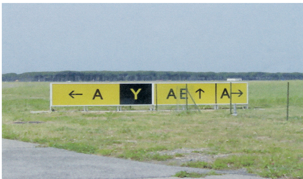
Cartello posizionato sulla destra della via di rullaggio Y, all'incrocio dei raccordi/vie di rullaggio Y, A, AE
