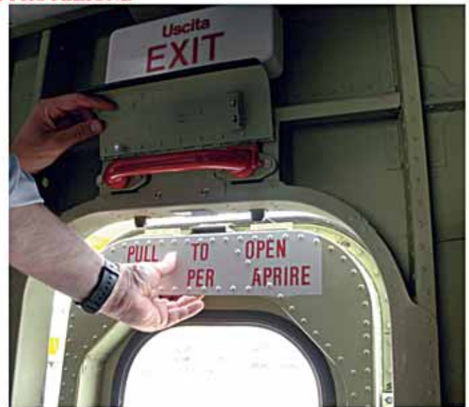
Foto n. 2: dettaglio della parte superiore della porta di emergenza; si notino i perni superiori estesi (maniglia non estratta).
