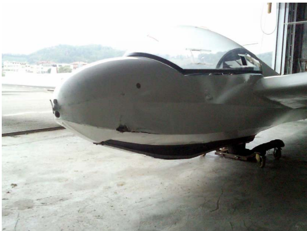
Foto 1: danneggiamento fusoliera e pattino in zona anteriore.
