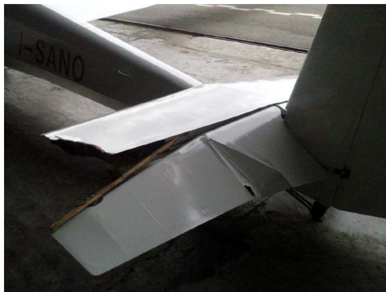
Foto 3: danneggiamenti piani di coda.
