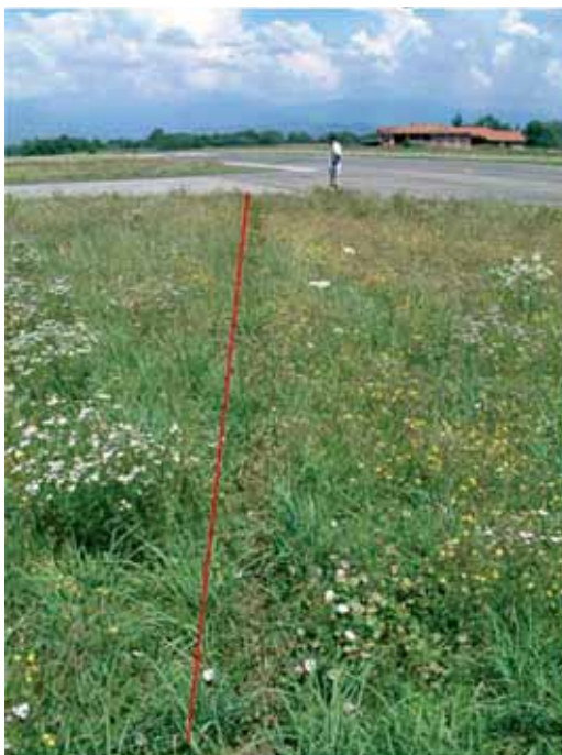
Strisciata del carrello d'atterraggio durante l'imbardata.
