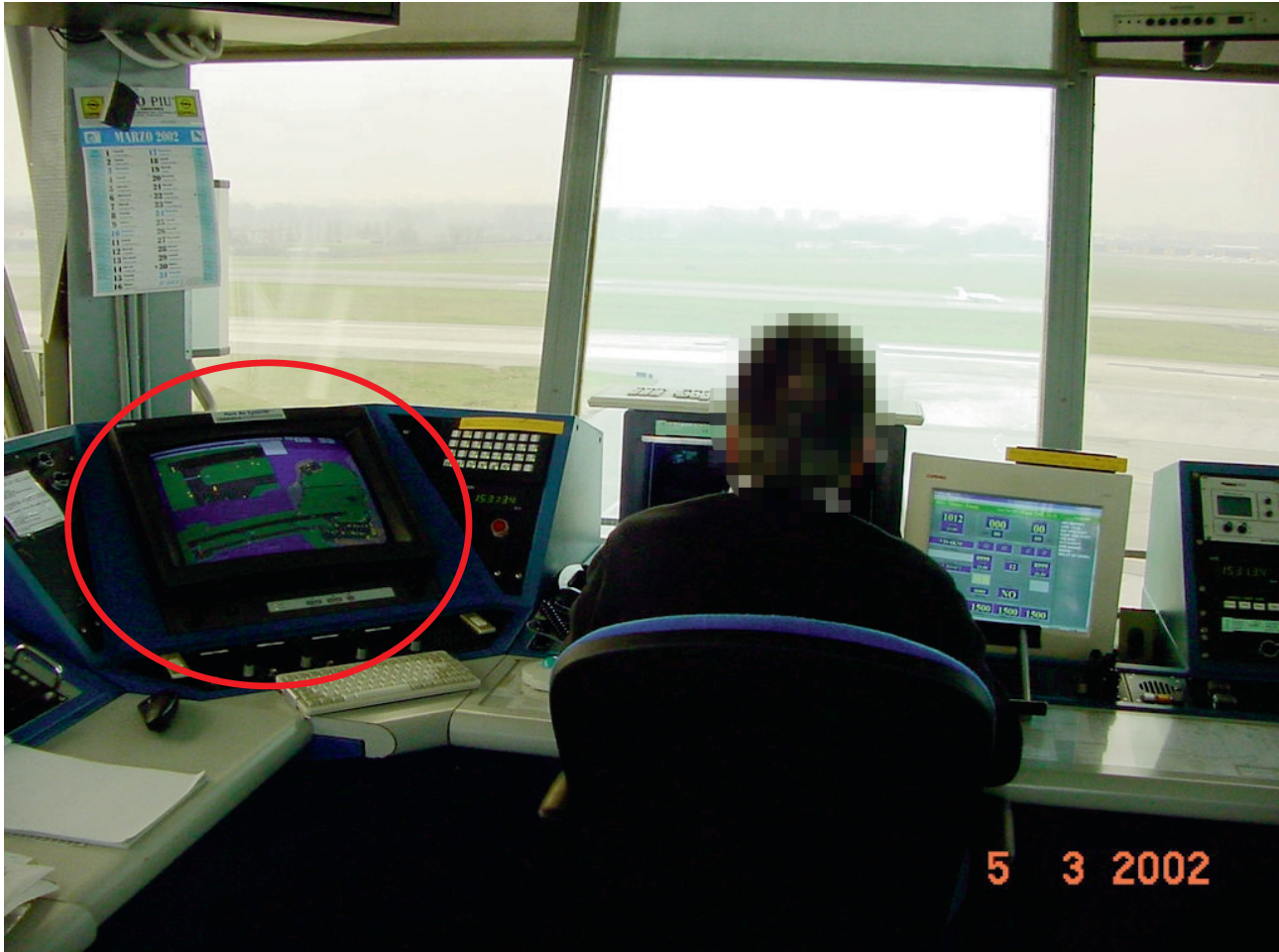
A sinistra dell'operatore di Torre è visibile il display del radar di terra.
