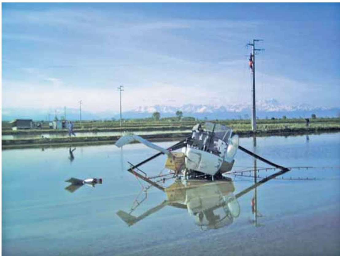
Posizione dell'a/m nell'impatto (si notino i piloni della linea elettrica principale).
