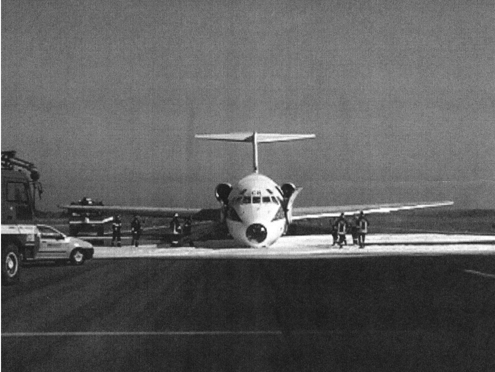
Aeromobile fermo in pista durante l'intervento dei VVF Notare lo scivolo anteriore sinistro non gonfiato
