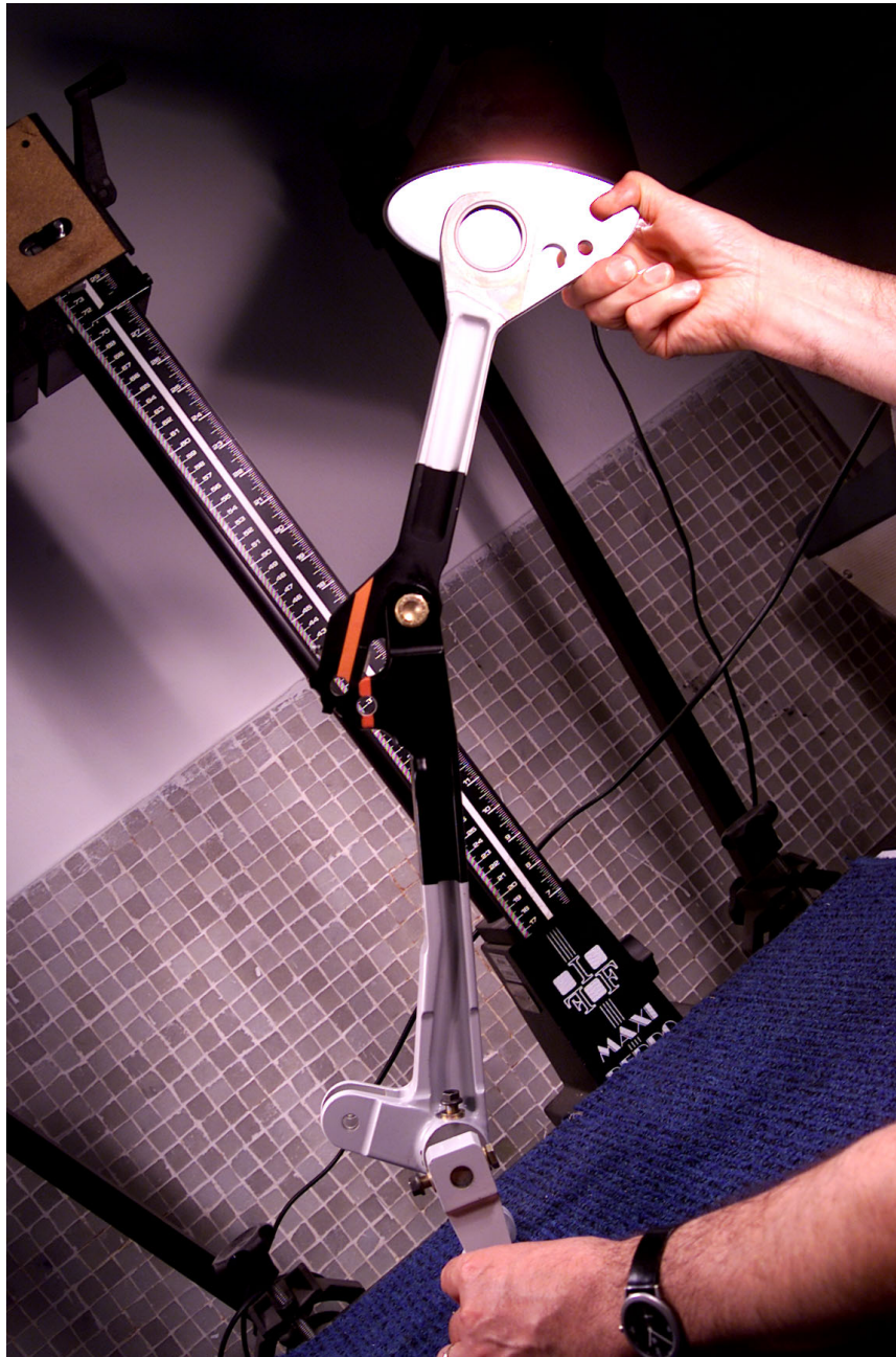
Meccanismo completo di blocco/sblocco carrello anteriore: NLG Lower and Upper lock link
