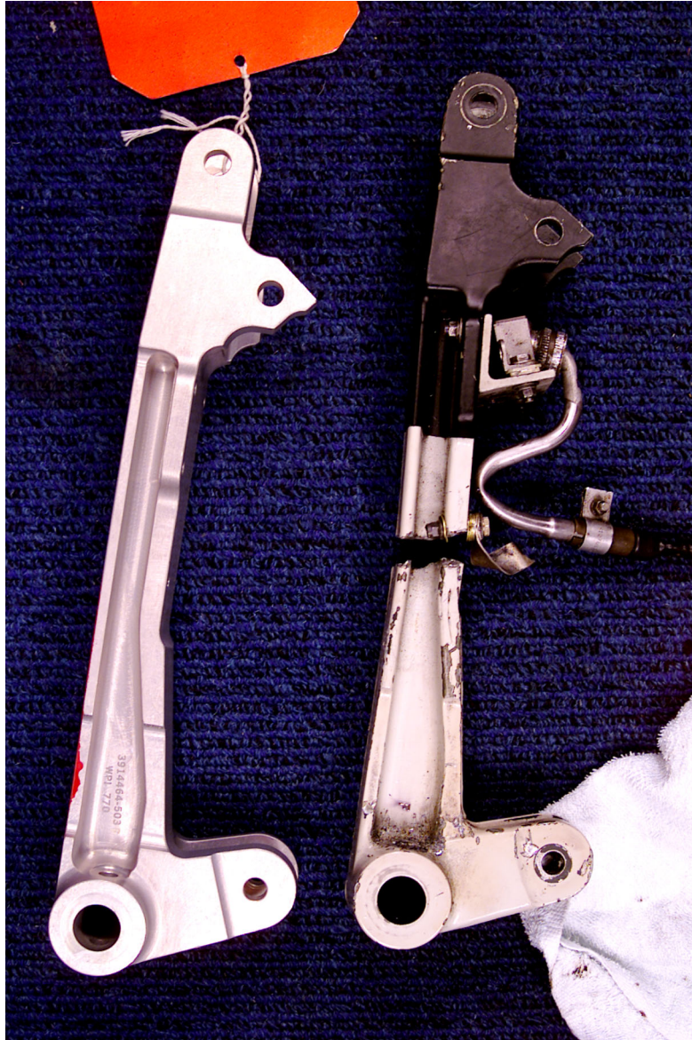
Confronto NLG Upper lock link . A sinistra vi è una nuova, a destra quella rotta rimossa dall'aeromobile
