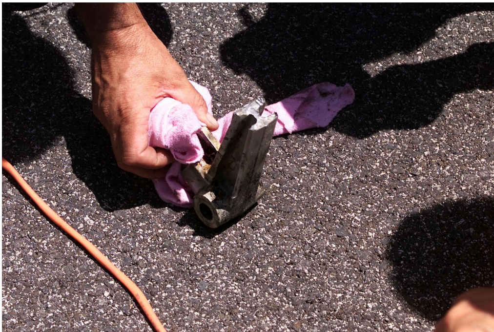
Parte del componente rotto smontato dall'aeromobile ancora in pista
