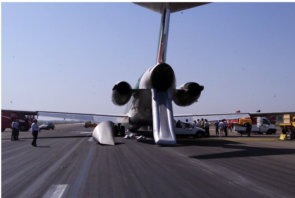
Vista posteriore. Notare lo scivolo del cono di coda in posizione estesa
