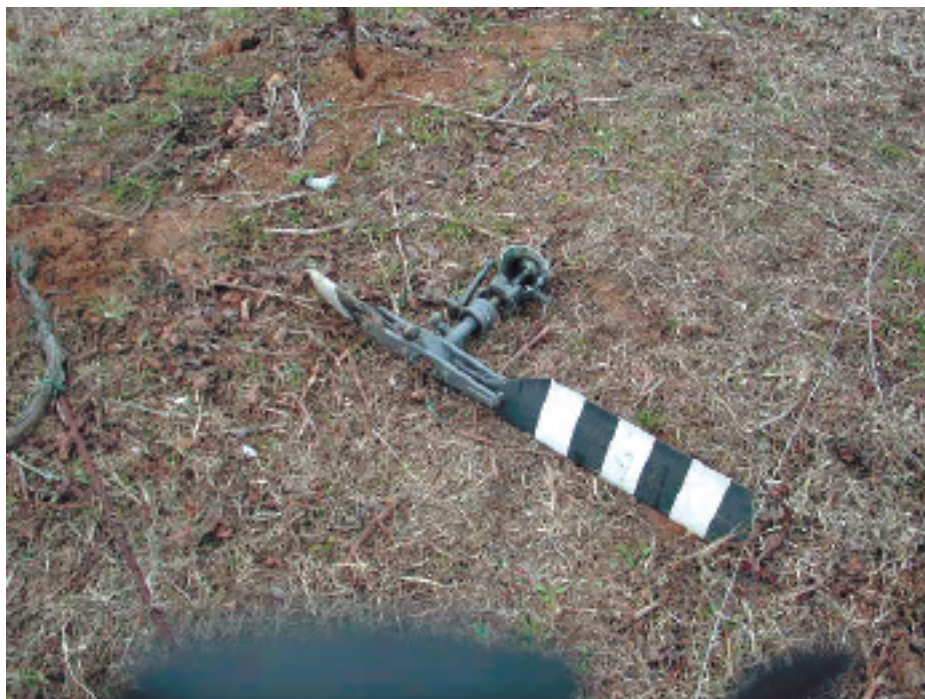
Assieme rotore di coda.
