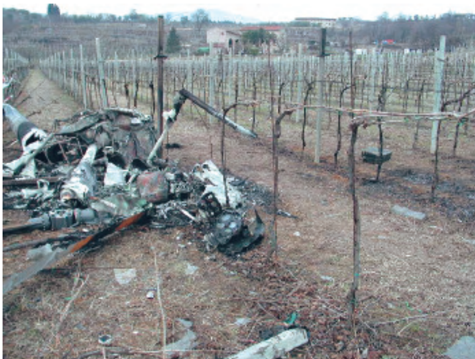
Parte anteriore distrutta dall'incendio.
