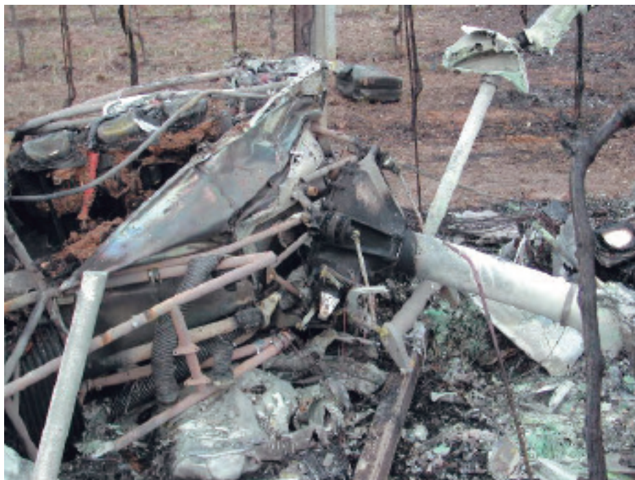
Assieme trasmissione principale.
