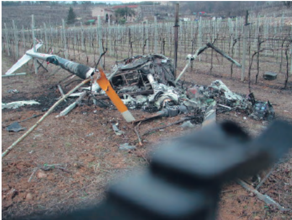
Mozzo rotore principale e pala s/n 1529.
