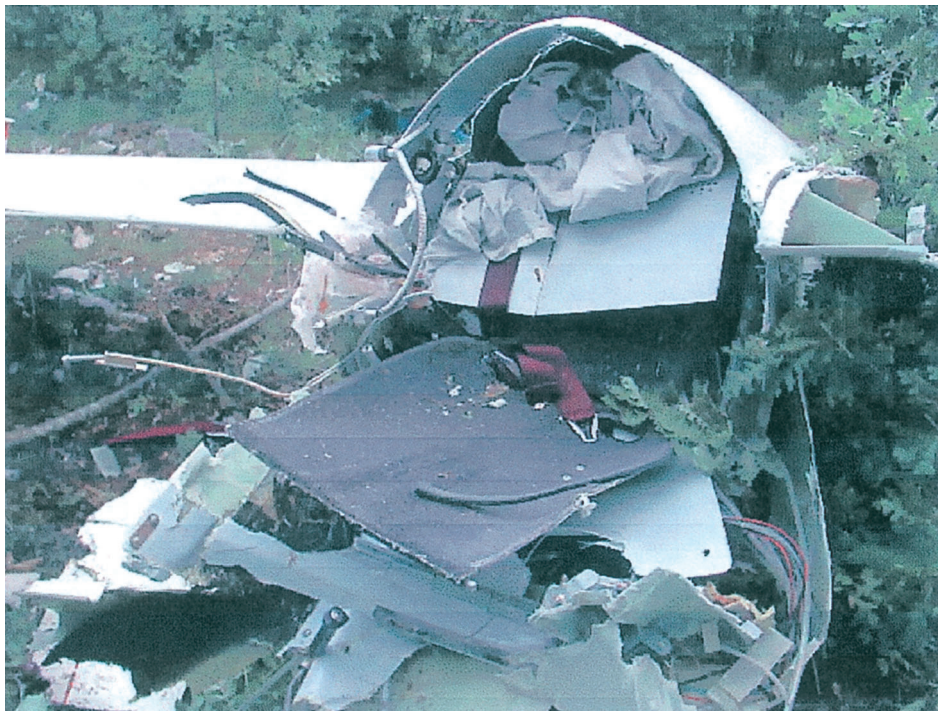
Particolare cabina di pilotaggio completamente distrutta
