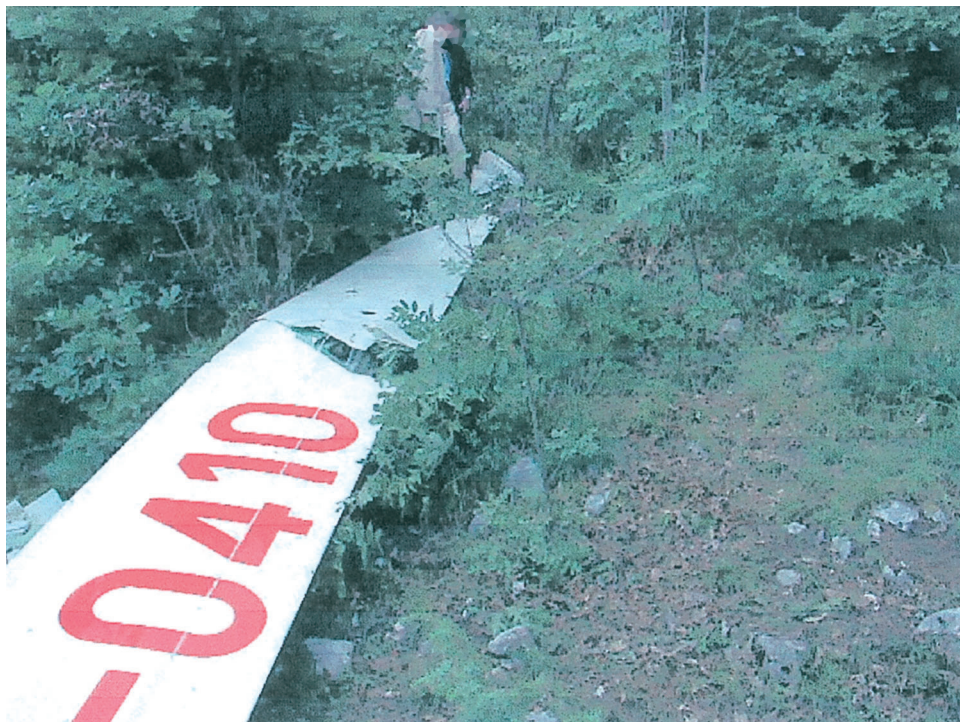
Particolare rottura semiala sinistra
