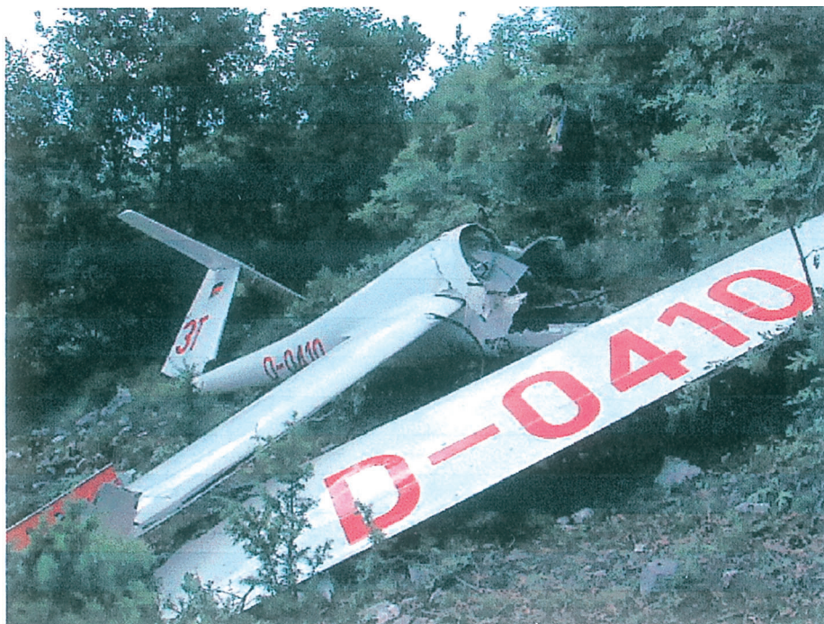
Vista frontale. Semiala sinistra separata dal relitto. Notare la cabina completamente distrutta
