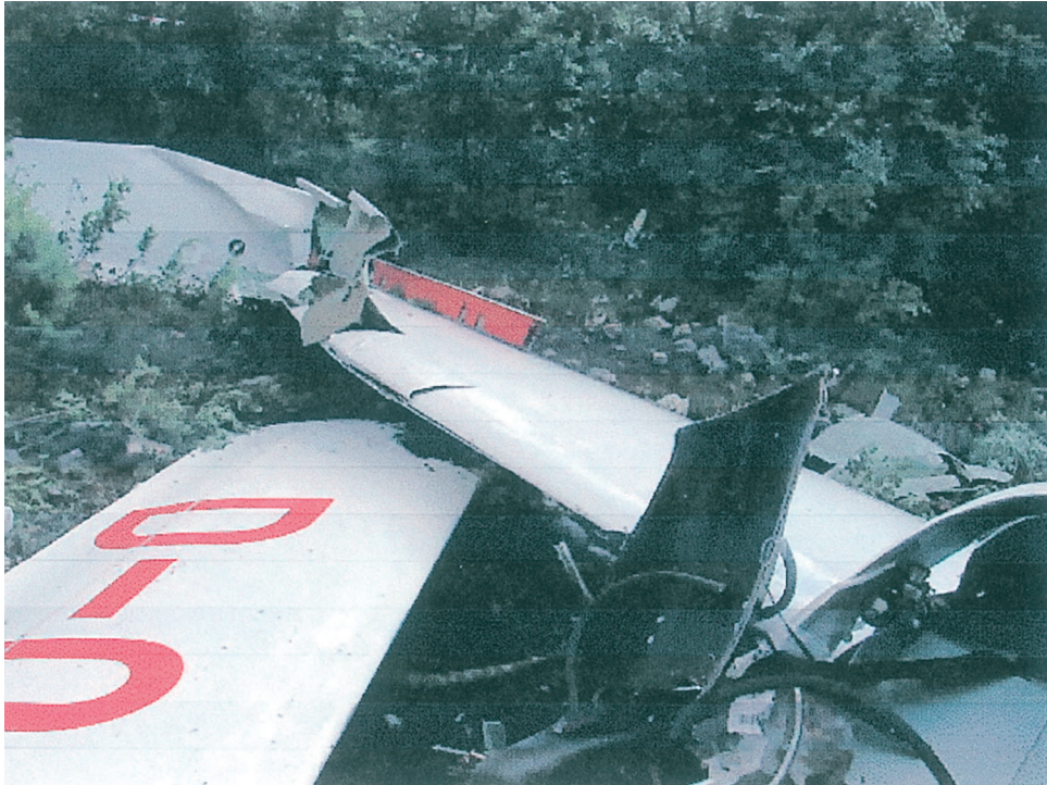
Particolare rottura semiala destra
