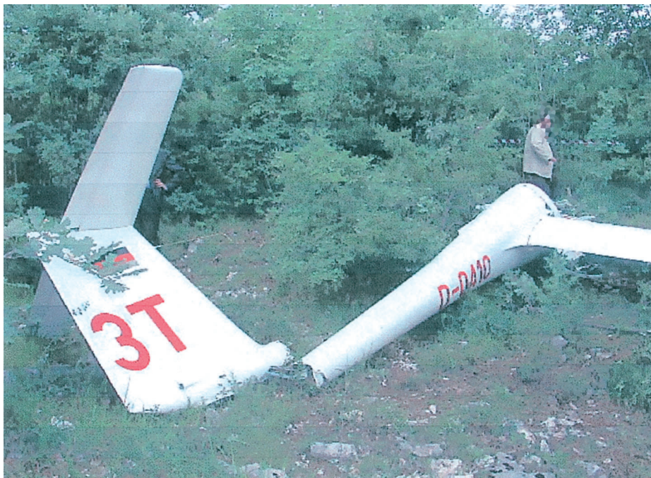
Relitto aliante. Vista posteriore. Notare la deriva separata dal resto del relitto
