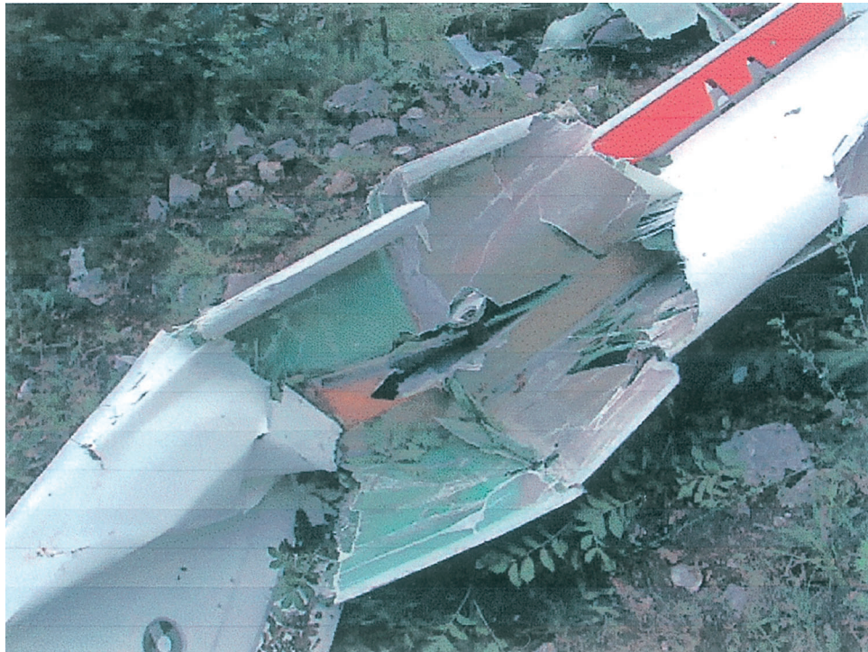
Particolare rottura metà lunghezza semiala destra
