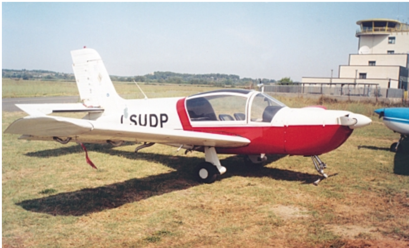
Aeromobile dopo l'evento, senza ruotino anteriore
