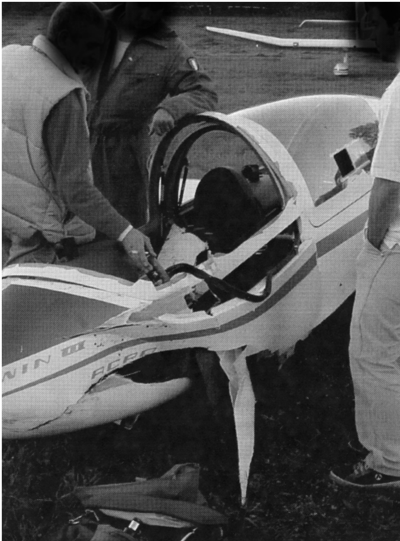
Danni riportati dalla cabina di pilotaggio
