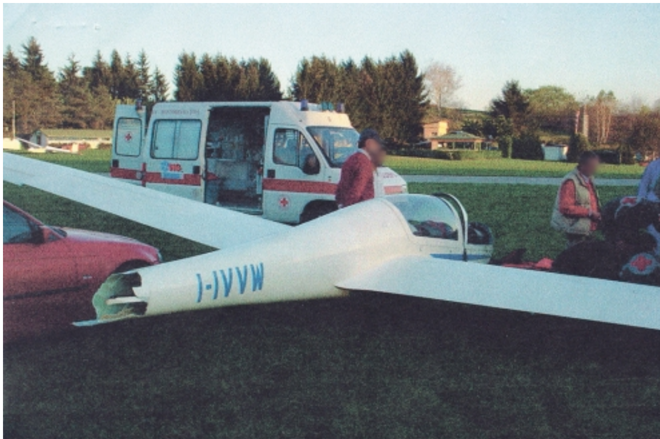
Aliante incidentato circondato dal personale di soccorso. Si evidenzia il distacco totale degli impennaggi
