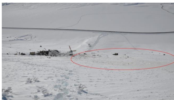
Foto 6: zona principale sversamento carburante e fluidi idraulici.
