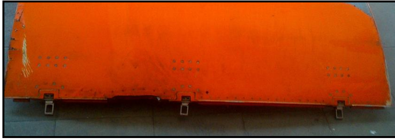
Foto 10: particolare cappottatura destra ( eye bolt ).
