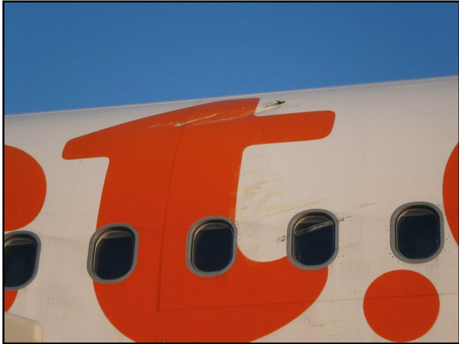
Foto 15: danni alla fusoliera.
