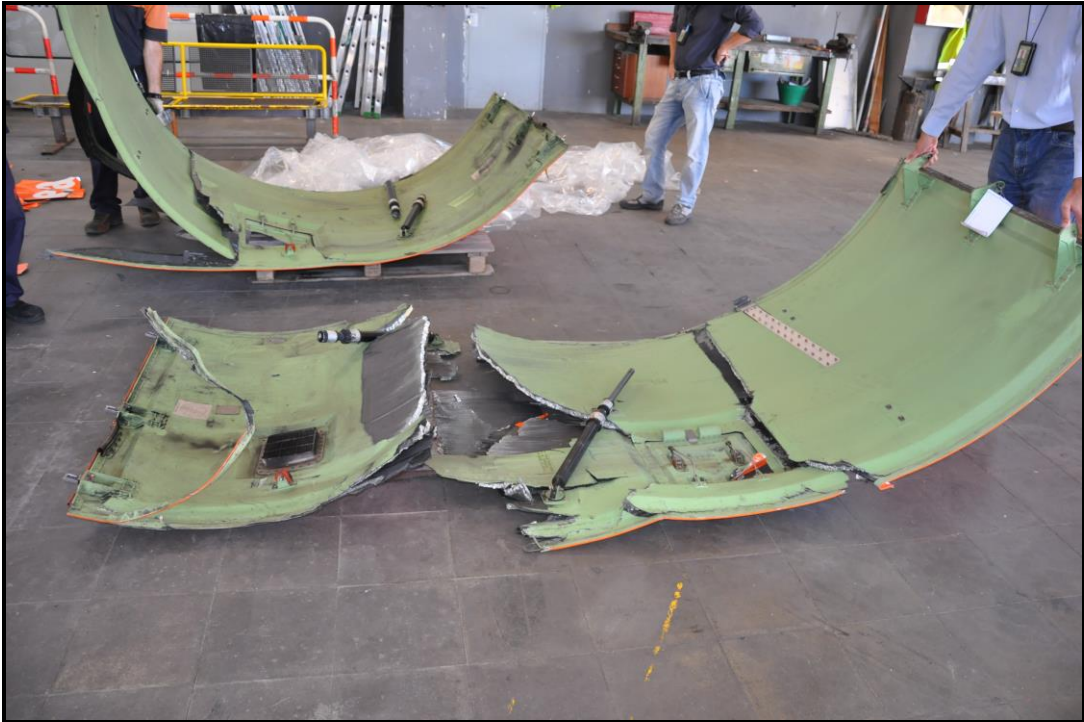
Foto 7: fan cowl smontate dal motore (parte destra).
