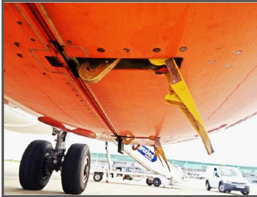
Foto 2: latch in posizione aperta ( left fan cowl door ).
