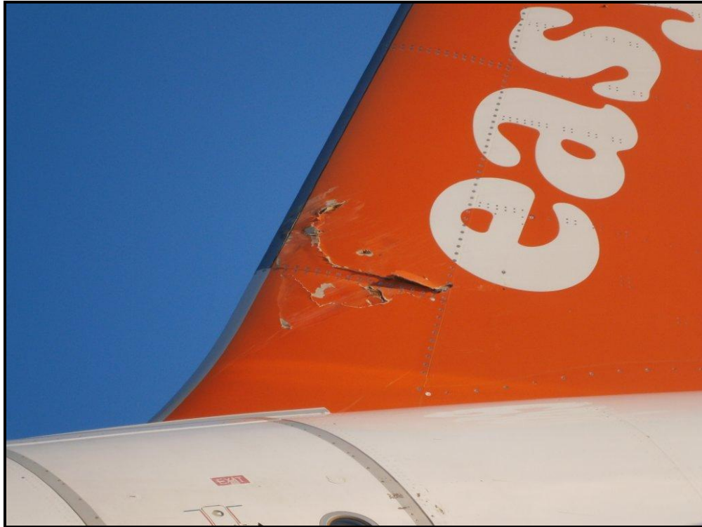
Foto 17: danneggiamenti sullo stabilizzatore verticale.
