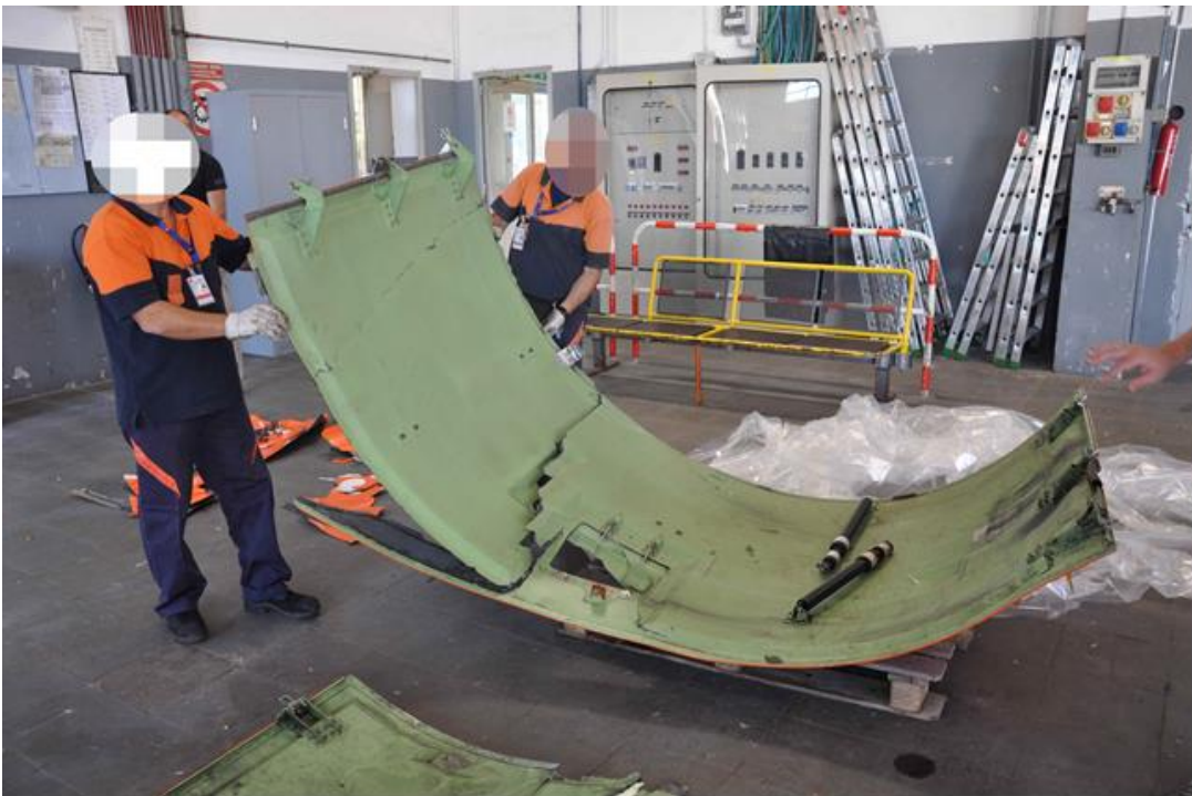
Foto 8: fan cowl smontate dal motore (parte sinistra).
