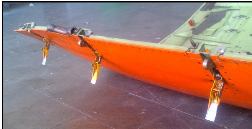
Foto 12: particolare cappottatura sinistra ( latch ).
