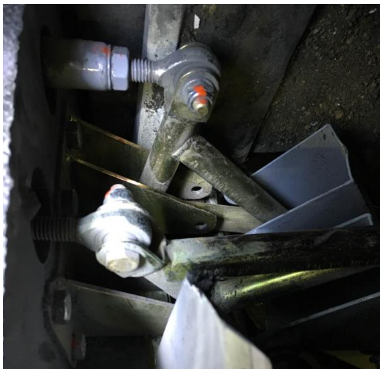
Foto 14: crankshaft aerofreno semiala sinistra, mancanza perno di rotazione.
