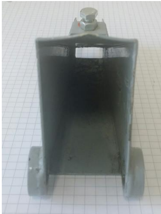
Foto 16: funnel comando crankshaft aerofreno semiala sinistra.
