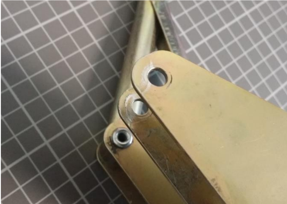
Foto 18: segni presenza perno rotazione sui supporti crankshaft aerofreni semiala sinistra.
