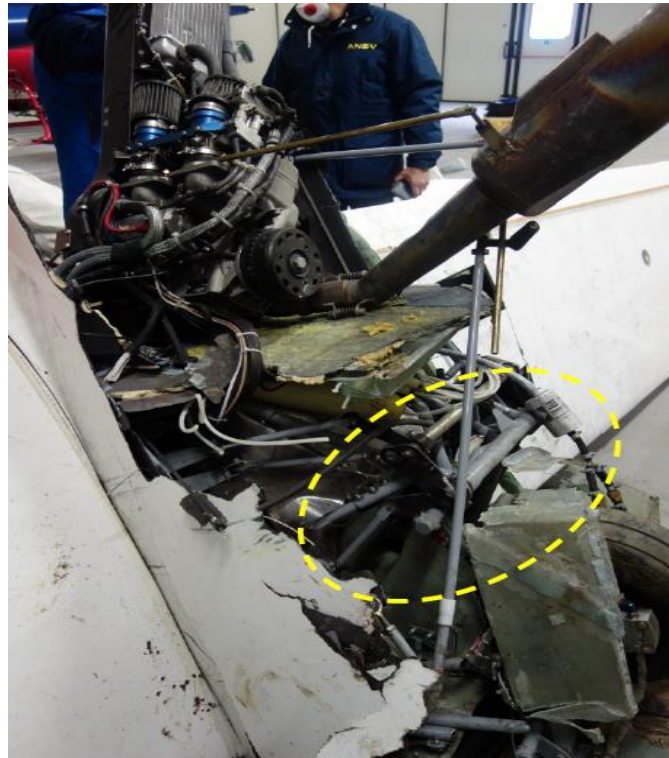
Foto 12: danni area torque tube aerofreni.
