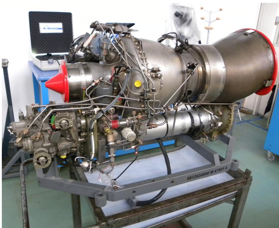
Foto 5: motore ARRIEL 1D1 rimosso dall'elicottero AS350 B2 marche I-AIRY.
