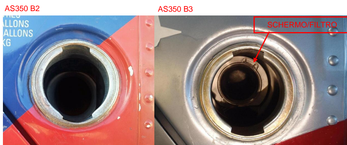
Foto 11: bocchettone carburante AS350 B2 senza schermo (sinistra) ed AS350 B3 con schermo (destra).
