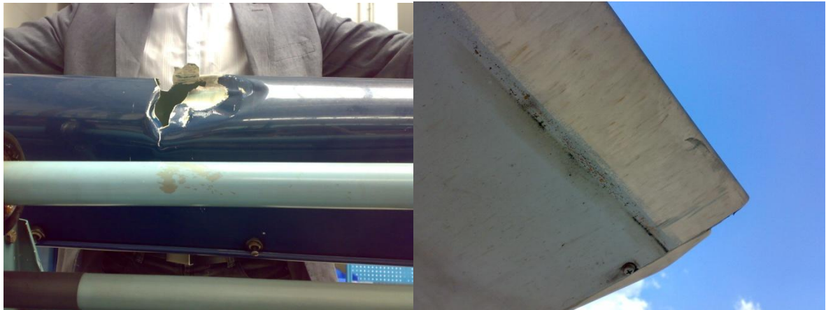
Foto 3: danni riscontrati sull’elicottero.
