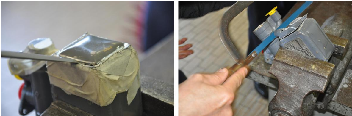
Foto 10: apertura dell' oil to fuel heater .
