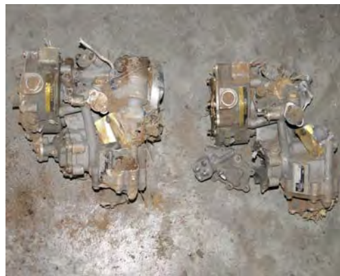
Foto 24: fuel control dei motori.
