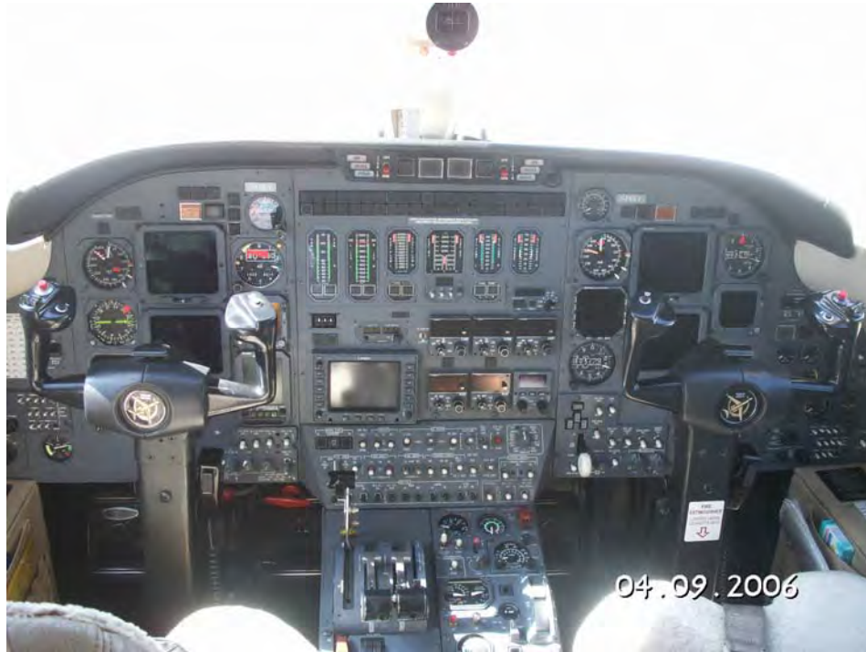
Foto 2: cockpit layout ed EFIS.
