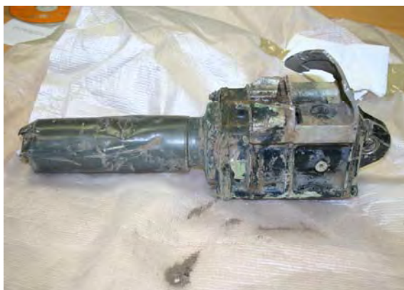
Foto 27: attuatore trim longitudinale.
