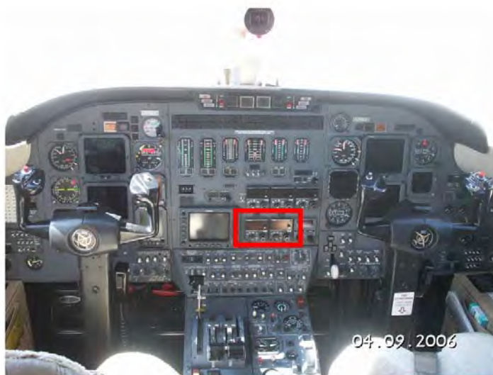
Foto 31: posizione quadro di controllo apparato VOR.
