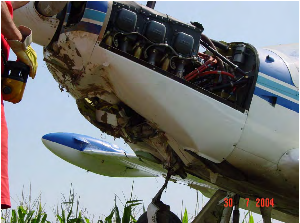
Foto n. 4: danneggiamenti parte inferiore del muso e carrello anteriore.
