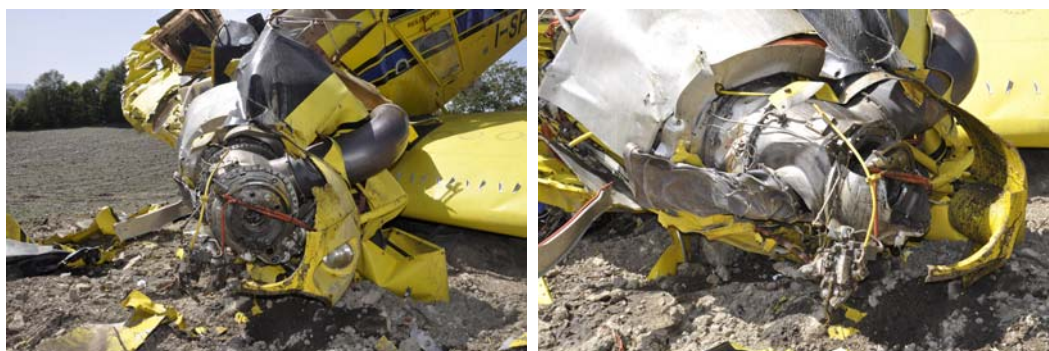
Foto 10 e 11: rotture castello motore e riduttore.
