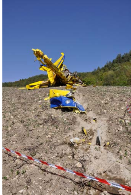
Foto 2 e 3: particolari sversamento carburante ed impatto della tip semiala destra.
