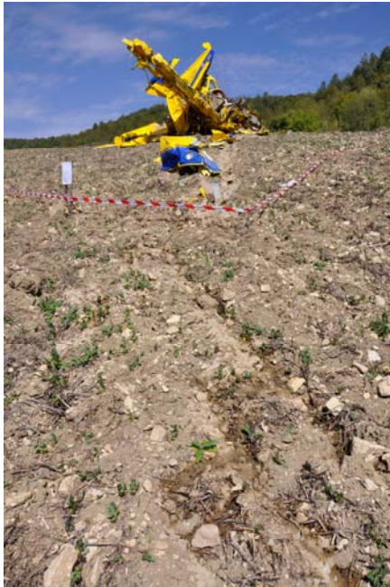
Foto 2 e 3: particolari sversamento carburante ed impatto della tip semiala destra.
