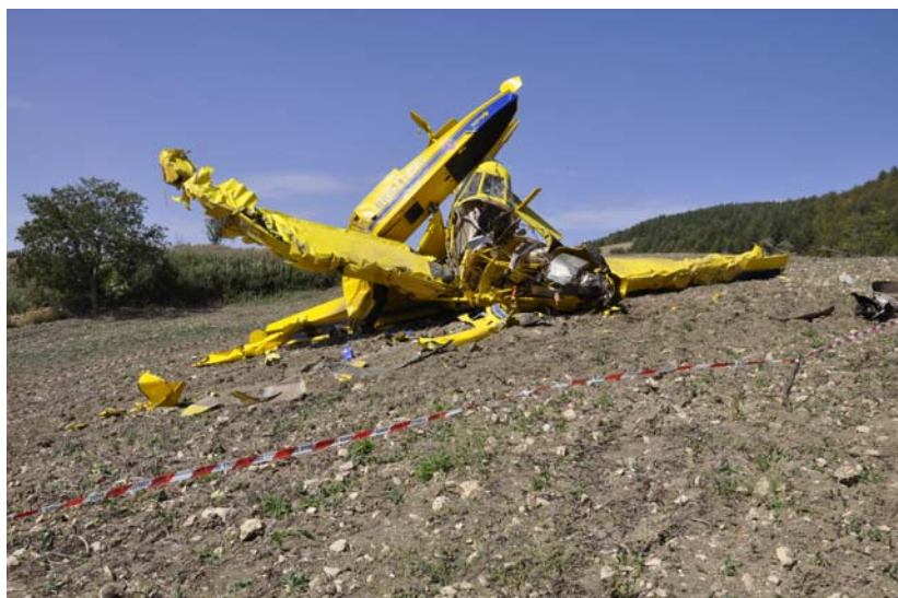
Foto 9: vista frontale danneggiamenti semiali e castello motore.
