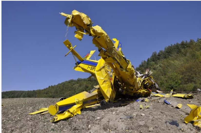
Foto 6: particolare deformazione bordo di attacco semiala destra.
