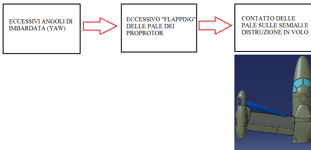
Figura 21: schema concettuale della modalità di impatto del propotor sulla semiala.
