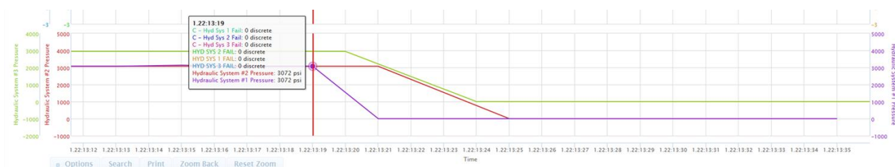
Figura 10: funzionamento degli impianti idraulici (dati FDR).
