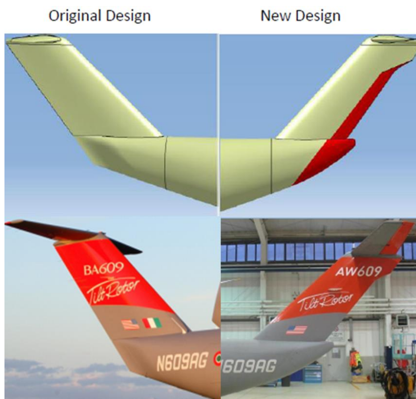
Figura 2: cambi strutturali della parte posteriore della fusoliera e deriva (tail fin).
