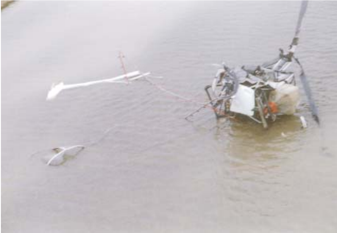
Particolare elicottero incidentato. Notare la trave di coda spezzata
