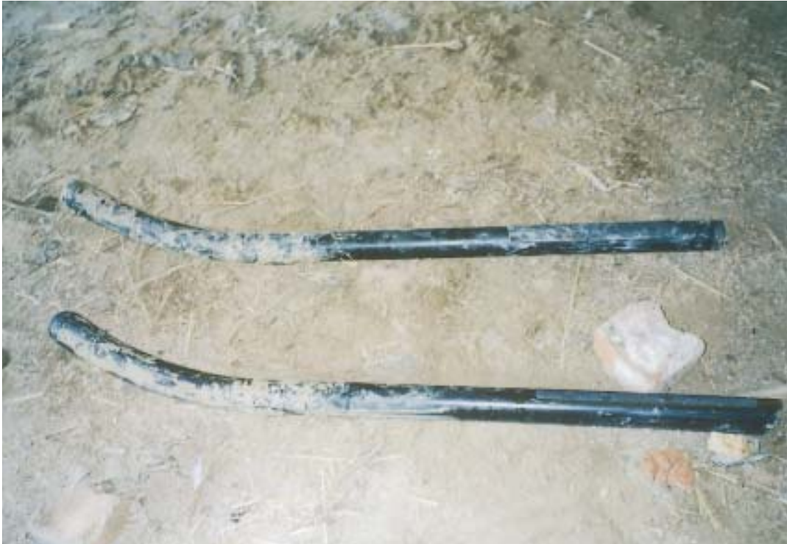
Parte dei pattini del carrello di atterraggio. Notare come la parte anteriore sia sporca di fango, essendosi conficcata nel terreno fangoso della risaia
