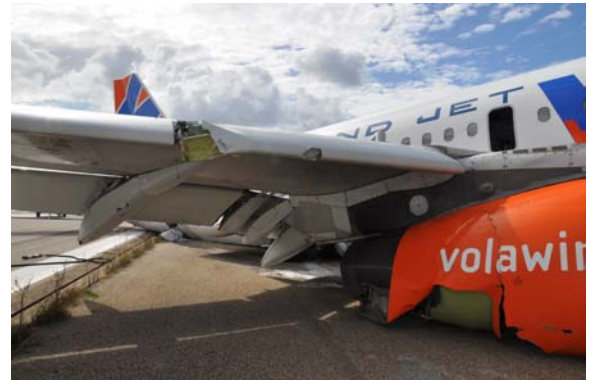
Foto 14: danni alla semiala destra.
