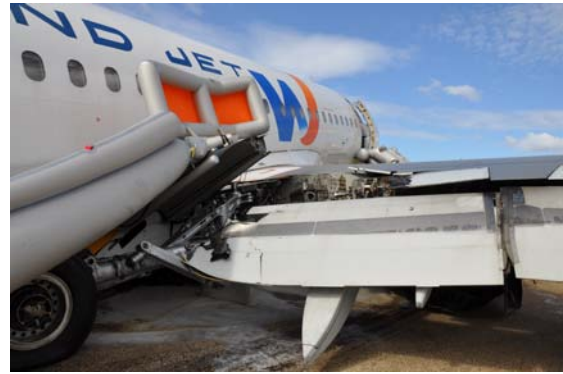
Foto 12: danni prodotti dal carrello destro.
