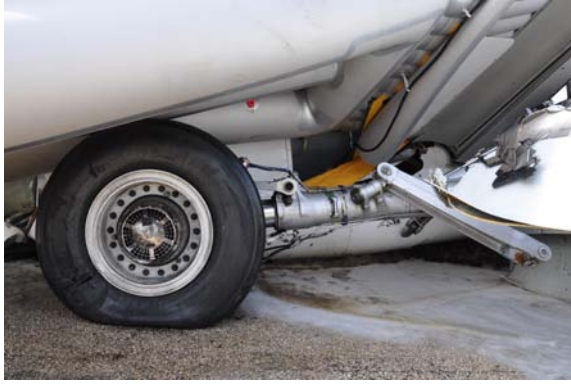
Foto 3: particolari dei danni al carrello destro.
