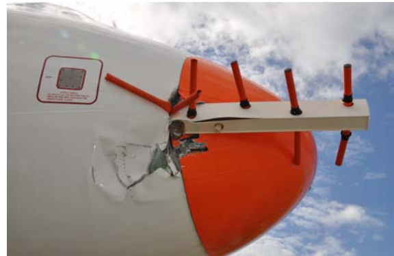
Foto 6: particolare dei danni al radome.
