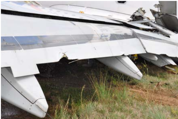
Foto 13: danni alla semiala sinistra.
