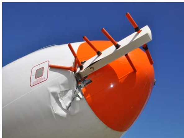
Foto 29: parte antenna localizzatore nel musetto.
