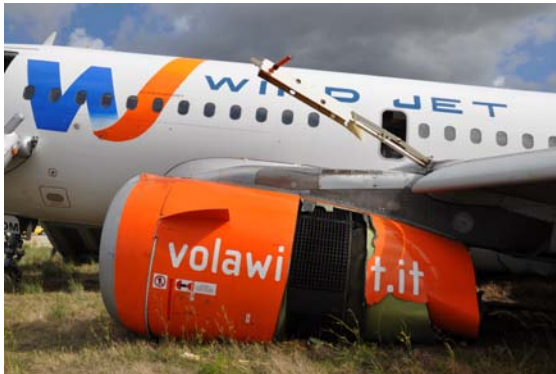
Foto 5: particolare dei danni al motore sinistro.
