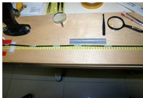
Foto 11: presenza di 6 giunture sul nastro del CVR.
