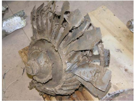
Foto 22: fan rotor motore destro.
