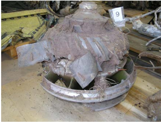
Foto 21: fan rotor motore sinistro.
