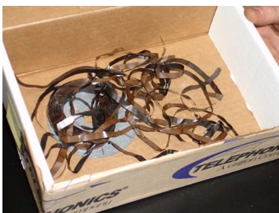
Foto 8: stato del nastro magnetico del CVR.
