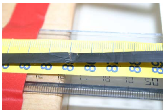
Foto 10: esame nastro CVR presso laboratori ANSV.
