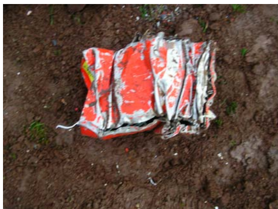
Foto 4: deformazioni subite dal FDR.
