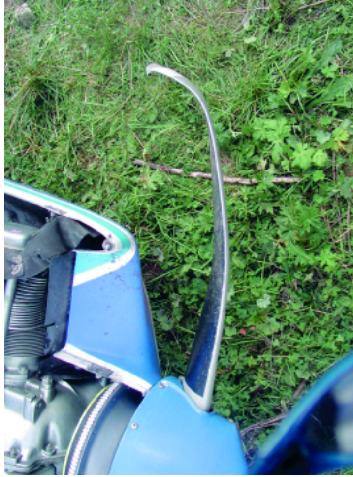
Deformazione e rottura di una pala dell'elica.
