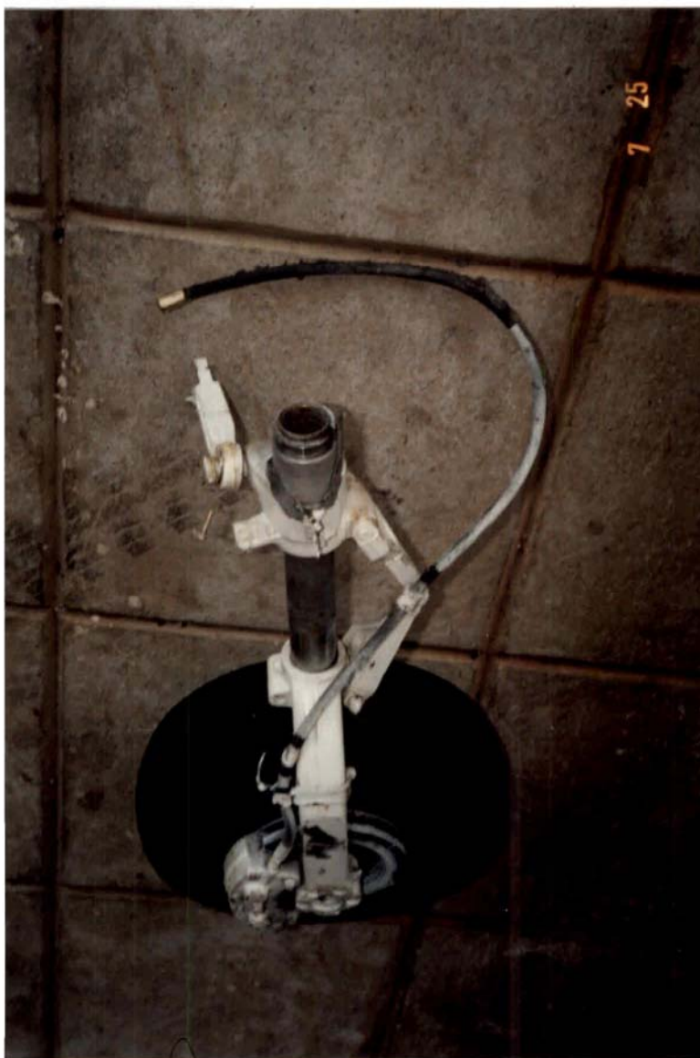
TREM PRINCIPAL DIREITO DA AERONAVE PIPER PA-34-220T, MATRÍCULA CS-ARM
