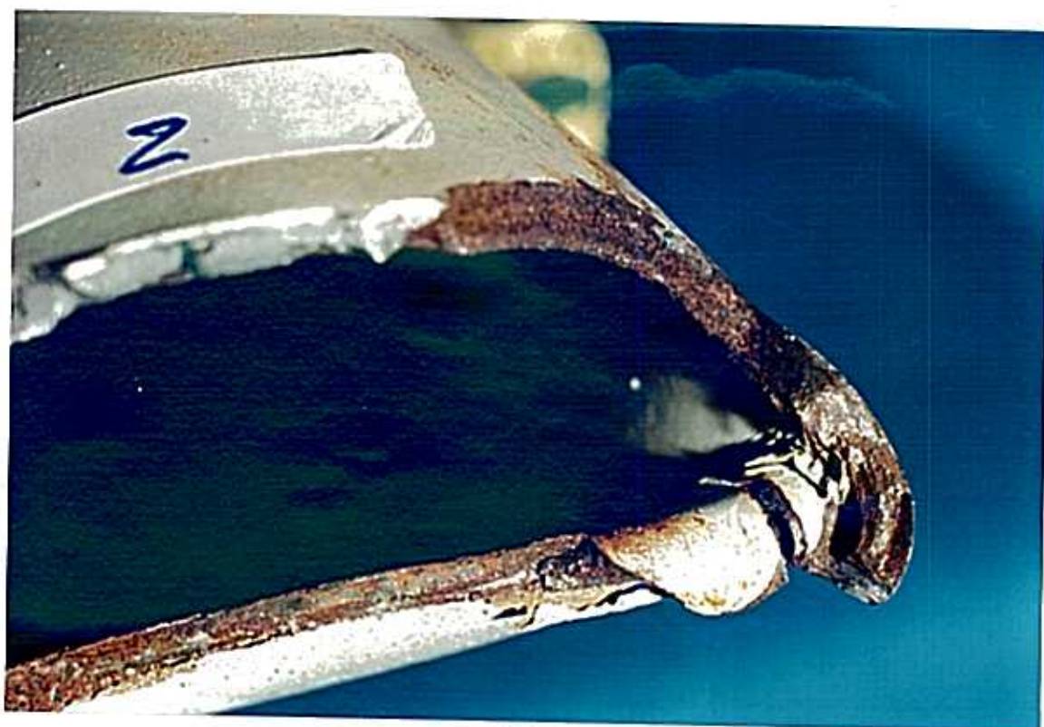
ROTURA DA TRAVESSA POSTERIOR LADO ESQUERDO (2)
