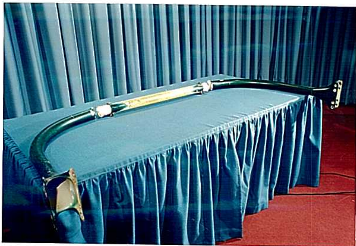
LOCALIZAÇÃO DAS ROTURAS NA TRAVESSA POSTERIOR
