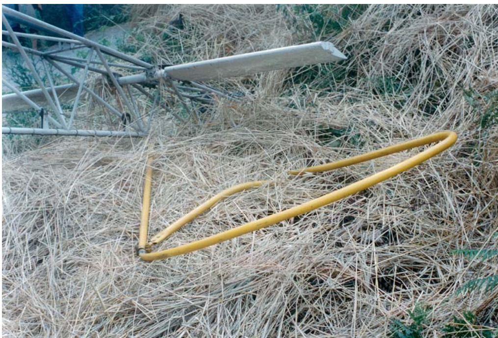
“BÉQUILLE” ARRANCADA DA ESTRUTURA
