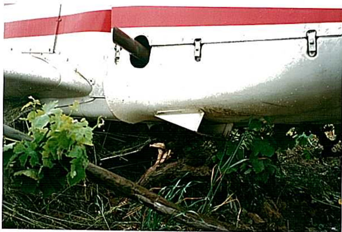
DANOS NAS CAPOTAGENS DO MOTOR
