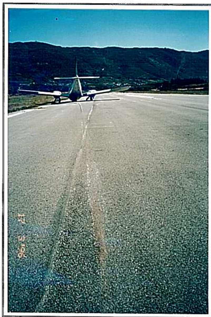
FOTO 4 - POSIÇÃO FINAL DO AVIÃO, LADO ESQUERDO DA PISTA 16, E SULCO DEIXADO PELO TREM DA RODA DE NARIZ DECEPADA
