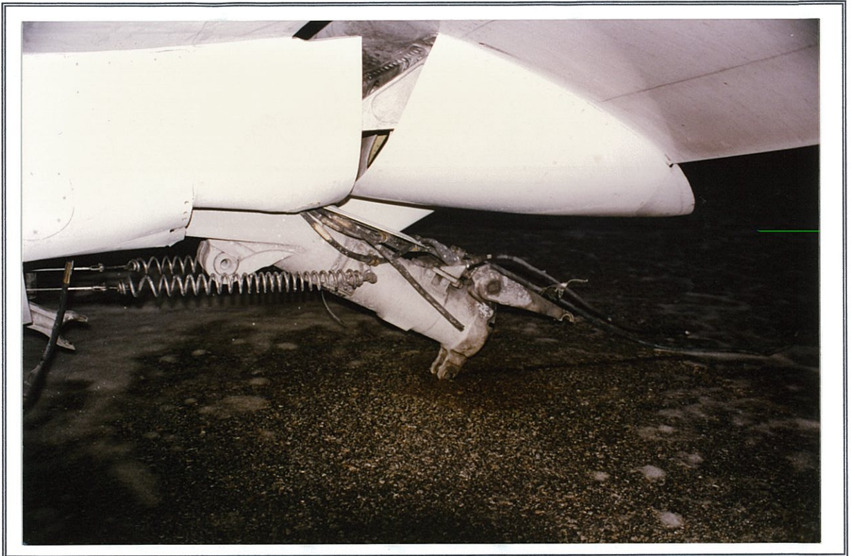
DANOS NO TREM PRINCIPAL ESQUERDO
