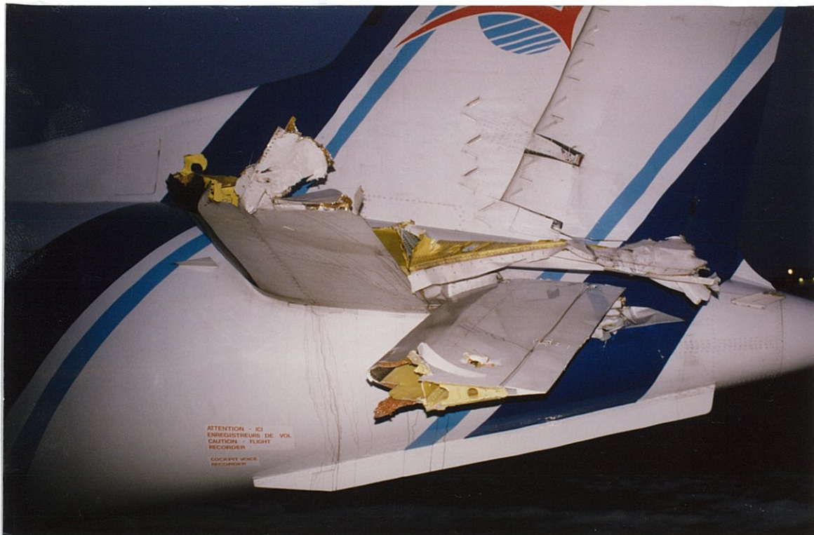
DANOS NO ESTABILIZADOR HORIZONTAL E LEME ESQUERDO
