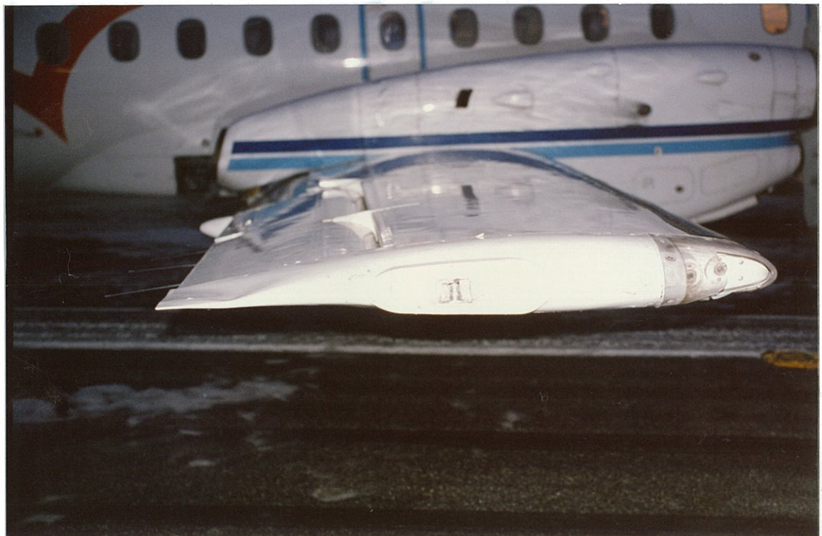
DANOS NO LADO DIREITO DA AERONAVE
