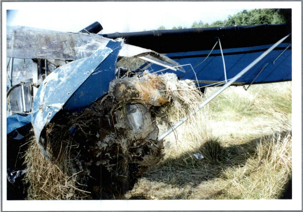
DANOS NO HÉLICE EVIDENCIANDO ROTAÇÃO NO MOMENTO DO IMPACTO
