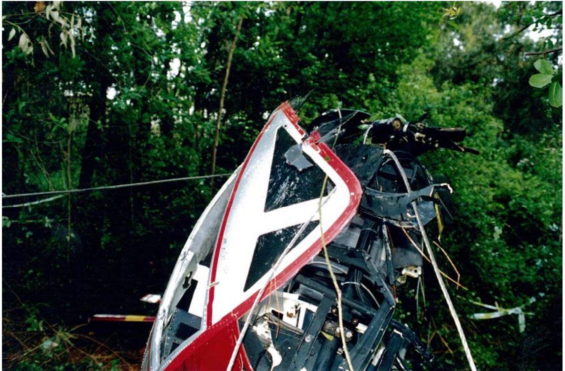
DESTROÇOS DA FUSELAGEM – CABOS ELÉTRICOS SECCIONADOS E ARRANCADOS PELO HELICÓPTERO
