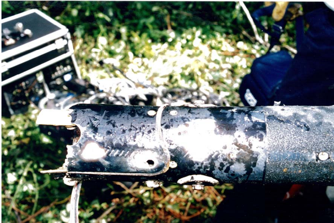
PATIM DIREITO FRACTURADO EVIDÊNCIA DE DESCARGAS ELÉCTRICAS
