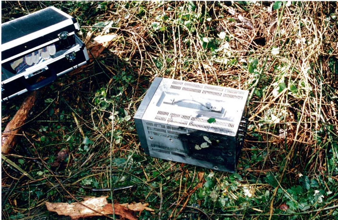
MONITOR VIDEO – EVIDÊNCIA DE DESCARGA ELÉCTRICA
