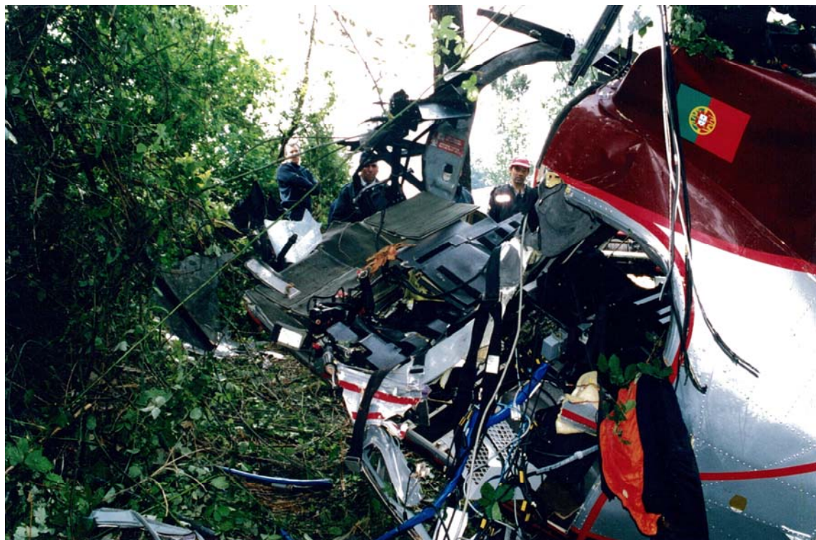
DANOS ESTRUTURAIS NA FUSELAGEM – LADO ESQUERDO
