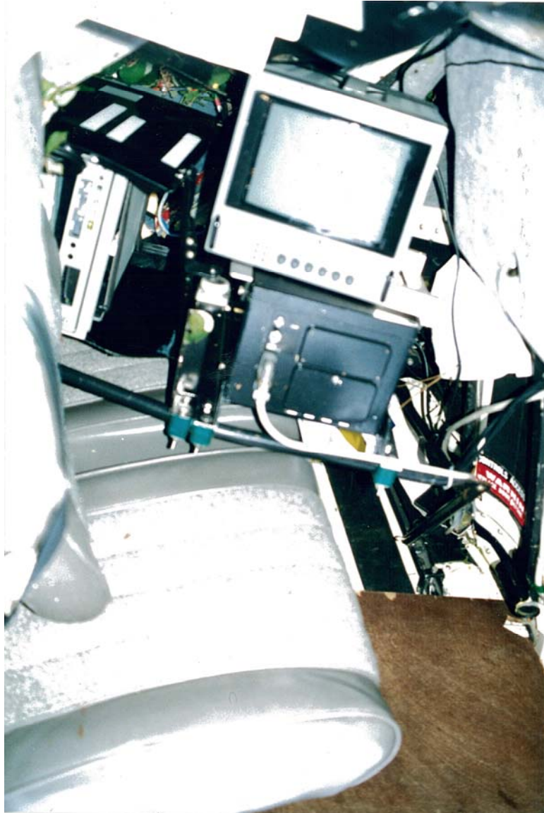
POSTO DO OPERADOR TRASEIRO DEFORMAÇÕES NA ESTRUTURA DE SUPORTE DOS EQUIPAMENTOS
