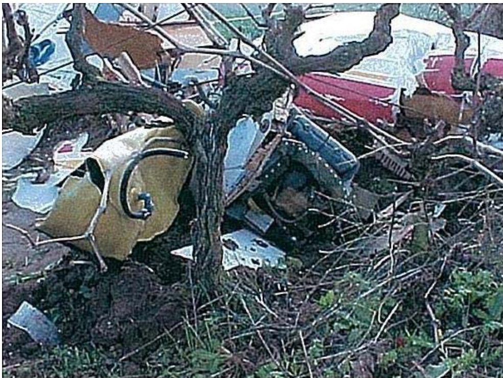
Foto 10 – Pormenor do depósito de combustível
