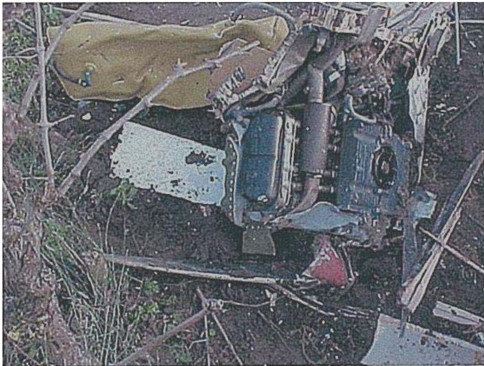
Foto 11 – Vista do hélice, motor e depósito de combustível
