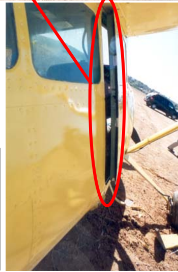
Fig. 3 – ▪ Pás do hélice dobrados; ▪ Enfolamento do revestimento do compartimento do motor; ▪ Porta inoperativa por possível deformação da estrutura.
