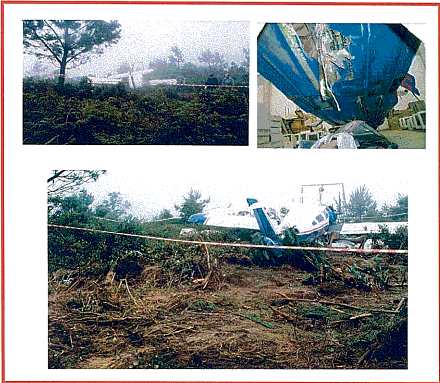
Sinais do arrastamento da aeronave no solo ao longo de 15,10 metros.
