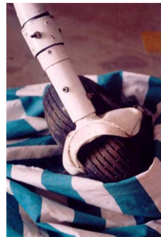
Figs. 3 e 4 – Garfo do trem e dojante empenados e pneu destruído.
