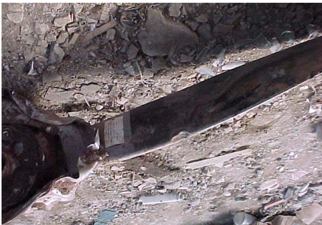
Foto Nº 4 – Pá do lado direito. (mossa na parte posterior do bordo de ataque)
