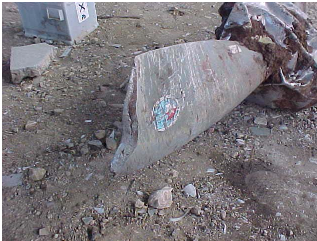
Foto Nº 3. Pá do lado esquerdo (fracturada e com marcas no extradorso)
