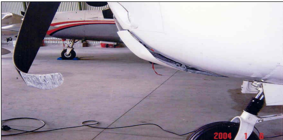
Foto1: Empenos da porta do trem e pontas das pás do hélice danificadas.
