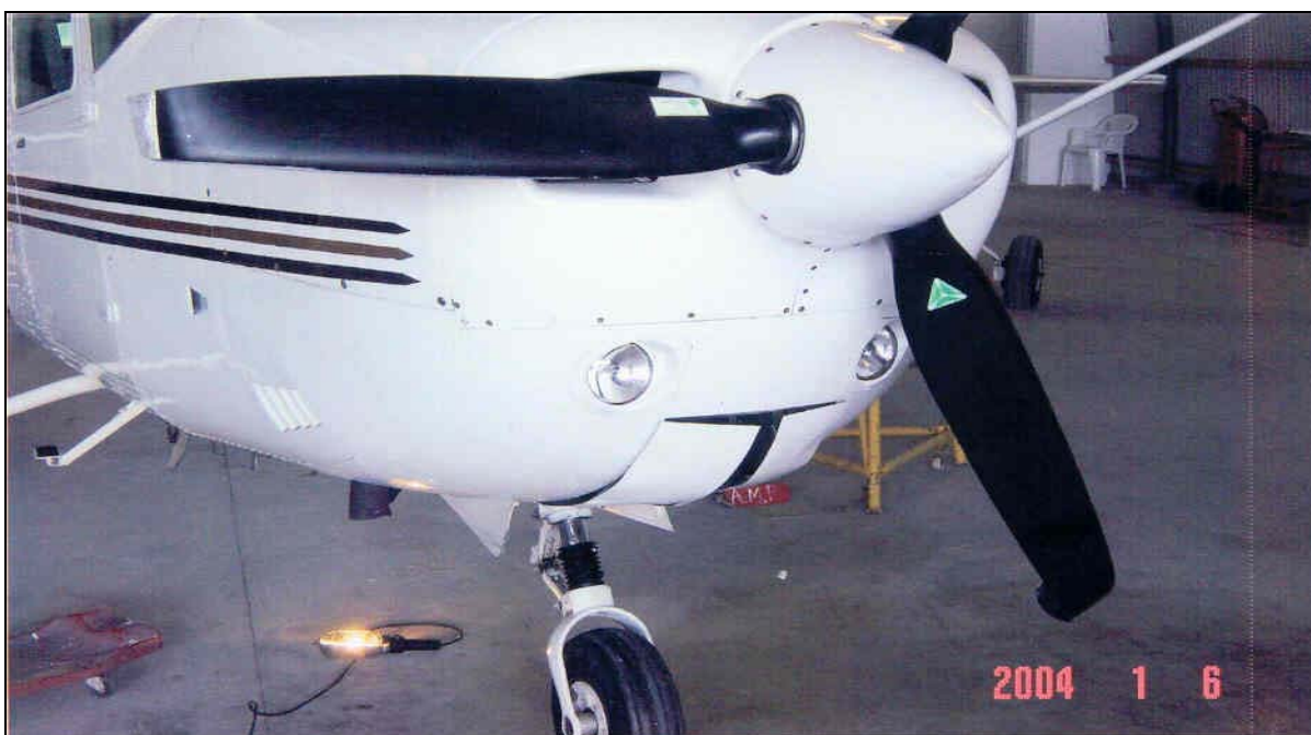
Foto 2: Pontas das pás do hélice danificadas.
