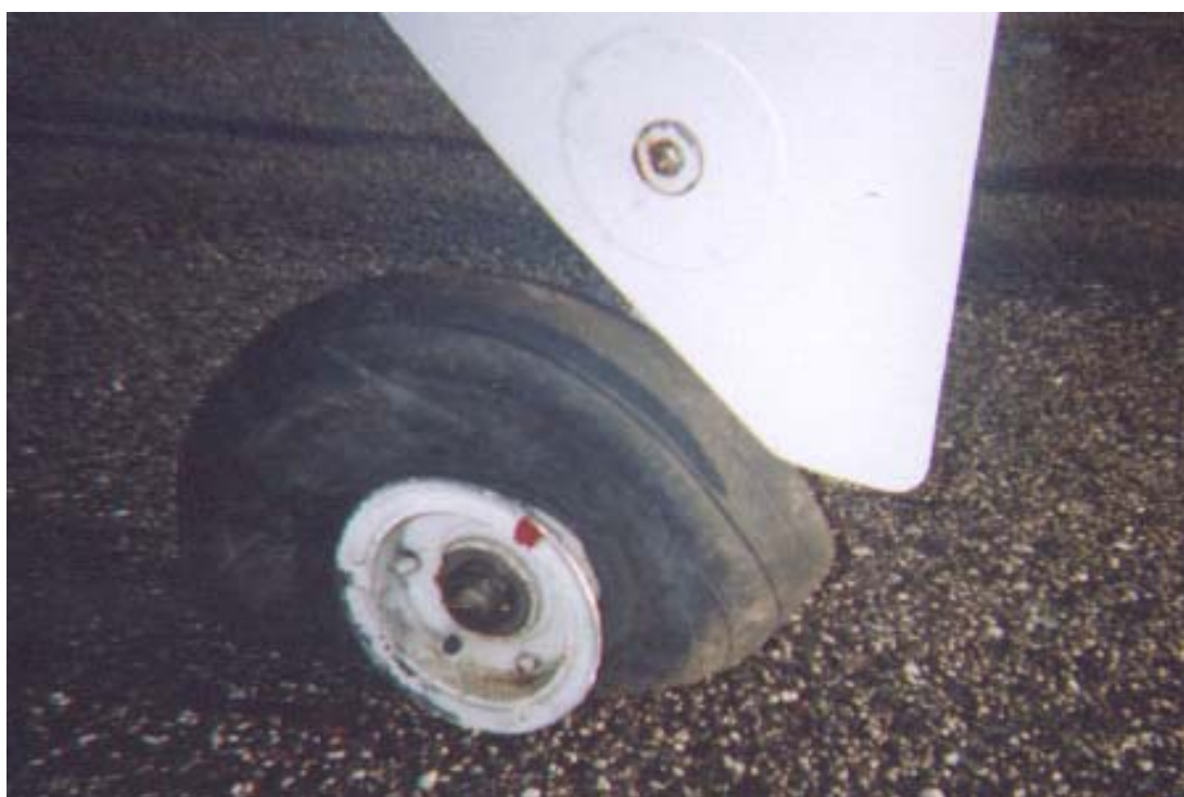
Fig. 3 – Danos na jante da roda direita, provocados pelo contacto com a superfície da pista.
