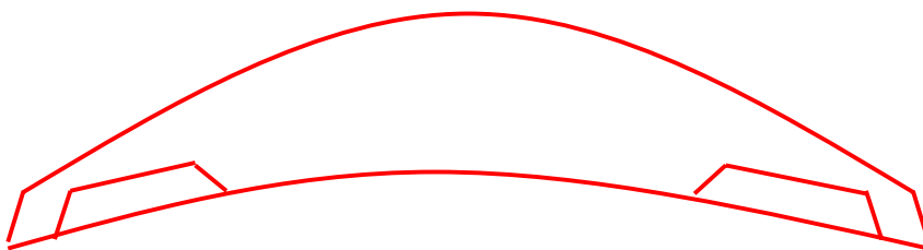
Fig. 23 - Aillérons embutidos na asa, mantendo-se a área alar.
