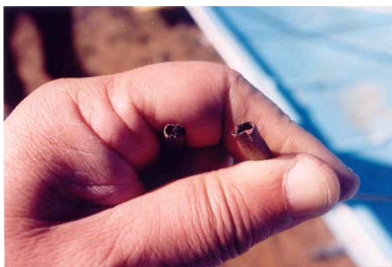
Fig. 20 – Os cabos do comando de direcção estavam separados. Haviam sido anteriormente emendados e justapostos por meio de uniões nicopress .
