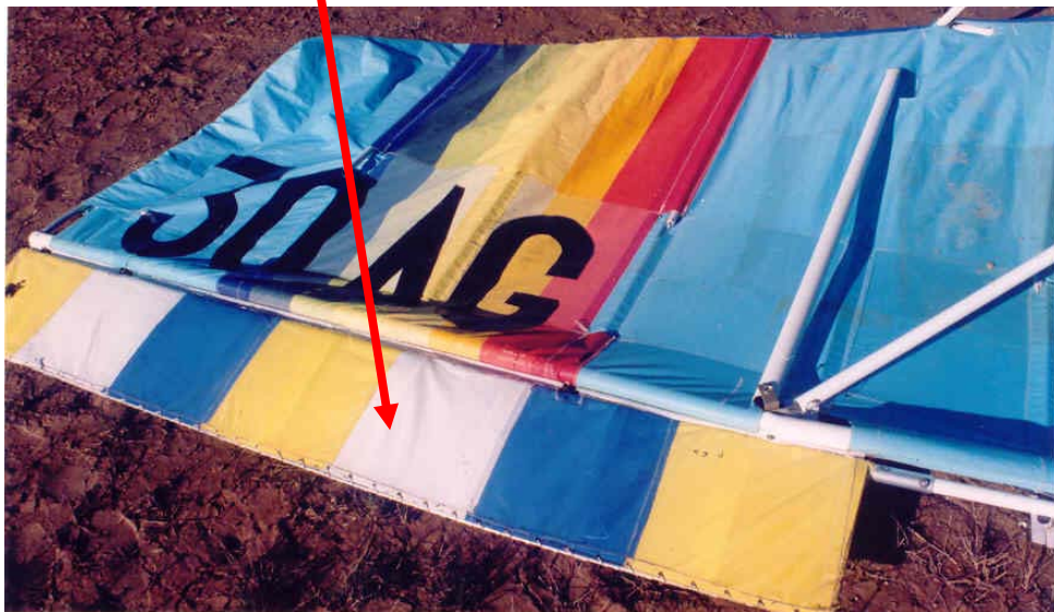
Figs. 12 e 13 – Os aillerons aplicados à asa.
