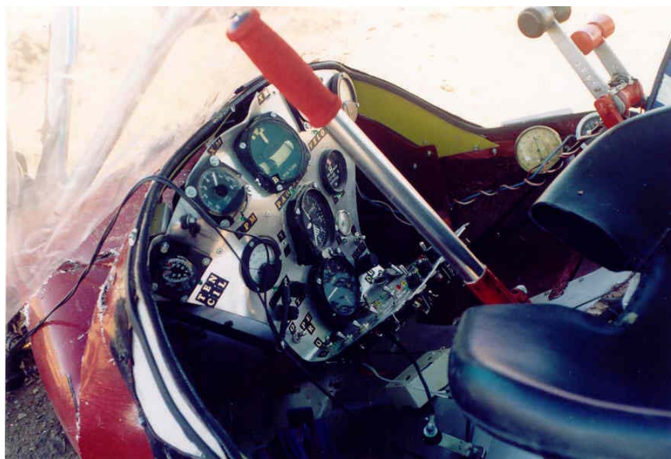
Fig. 11 – O painel e o manche do Weedhopper 30-AG após as modificações introduzidas pelo piloto.
