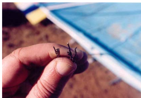
Fig. 21 – As extremidades dos cabos de comando de direcção apresentavam-se desfiadas por quebra provocada por tracção dos cabos.
