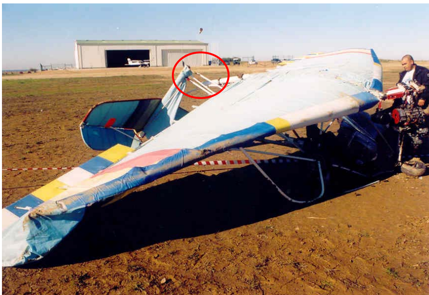
Fig. 19 – ...e quebrou também a seguir às asas, em consequência do embate com o solo.
