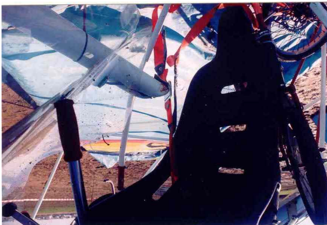
Fig. 18 – O tubo principal de suporte da estrutura fraccionou atrás do motor e penetrou na cabine...
