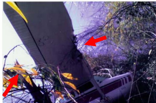
Figura 2 – Asa direita danificada.
