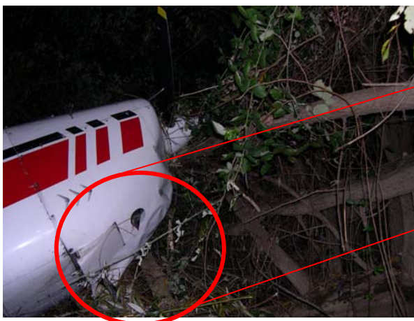
Figuras 4 e 5 – Danos no capot do motor e trem de proa.
