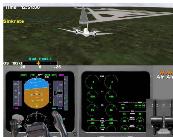
Figura 10 – 550 pés, 7,5° de pitch down e VAI de 173 kts
