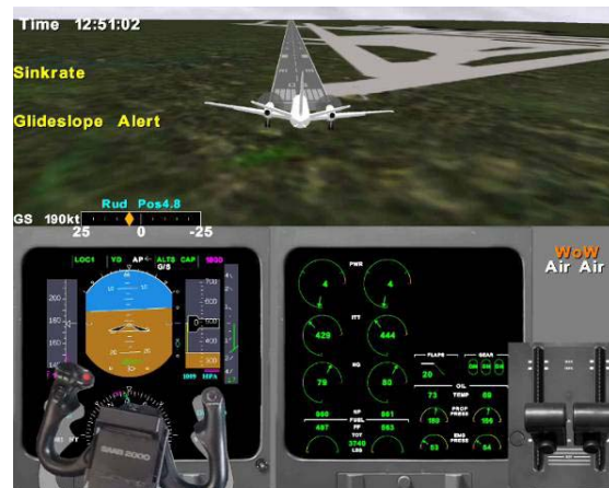
Figura 12 – Aviso de sinkrate e alerta de ladeira.
