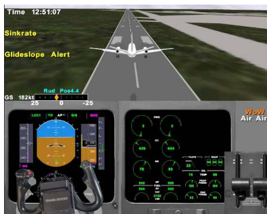
Figura 14 – 4º e último aviso de sinkrate e alerta de ladeira.
