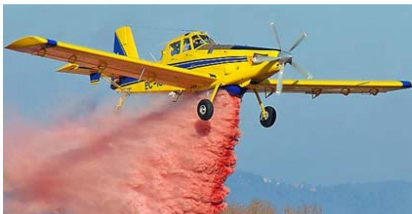
Figura N° 4 – Manobra de descarga
