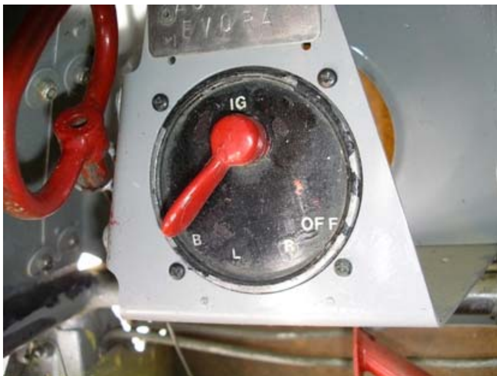
Foto 11 – Controlo de ignição na posição “Both”
