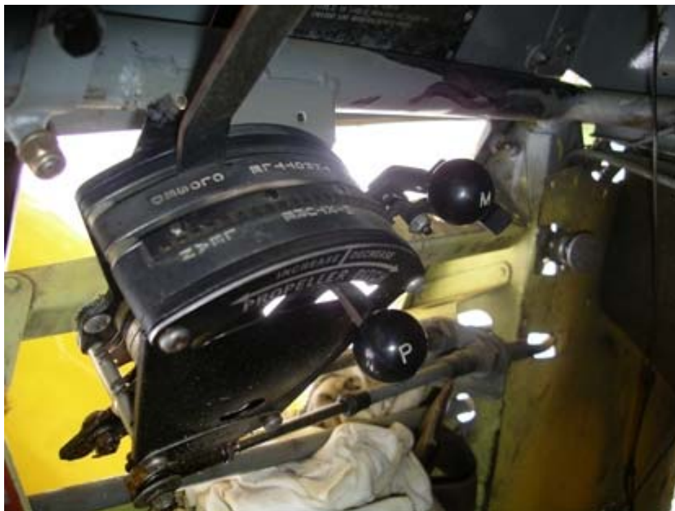
Foto 13 – Controlos de válvula do carburador, mistura (rica) e passo (fino)
