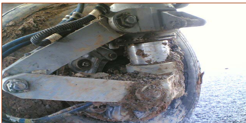
Fotografia N°3. Perna direita do trem com lama agarrada.
