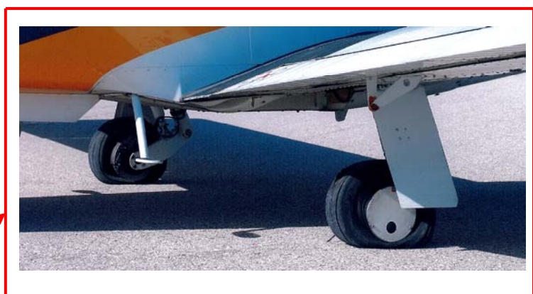
Figs. 1 e 2 – Pneus do trem principal rebentados.
