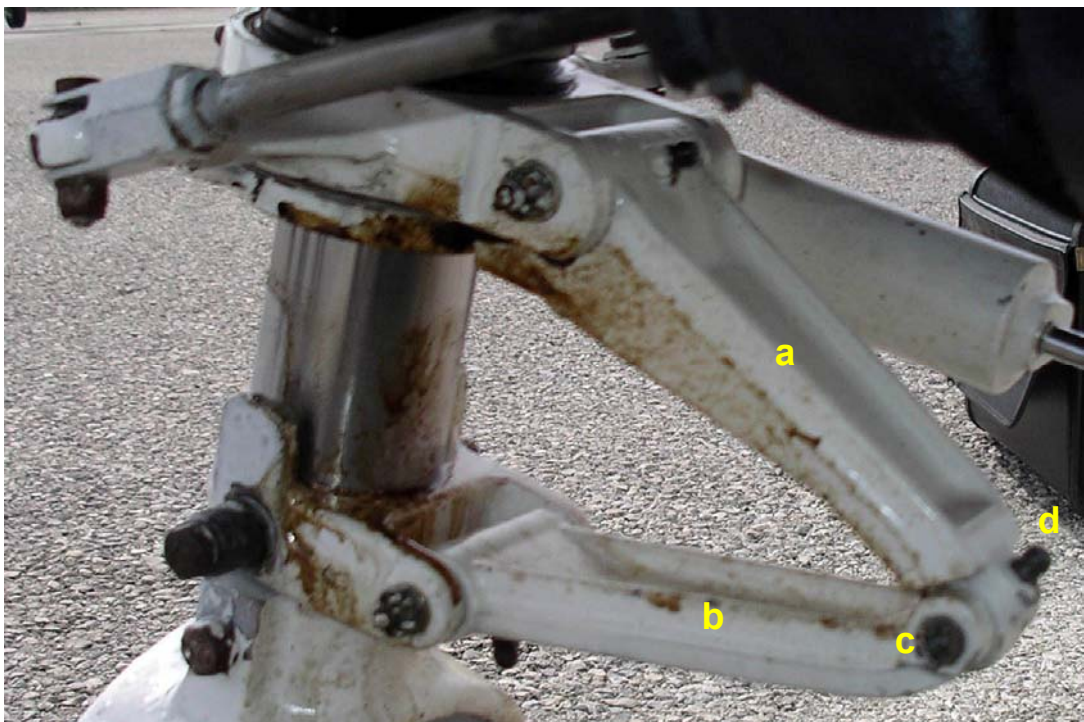
Fig. 15 - O trem de proa de um Cessna do mesmo modelo do CS-DDP com o torque link em evidência.
