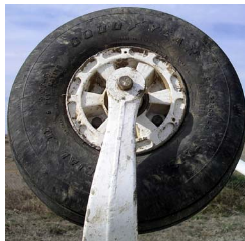
Fig. 13 – Vestígios de arrasto na parede do pneu e de erosão na jante de alumínio.
