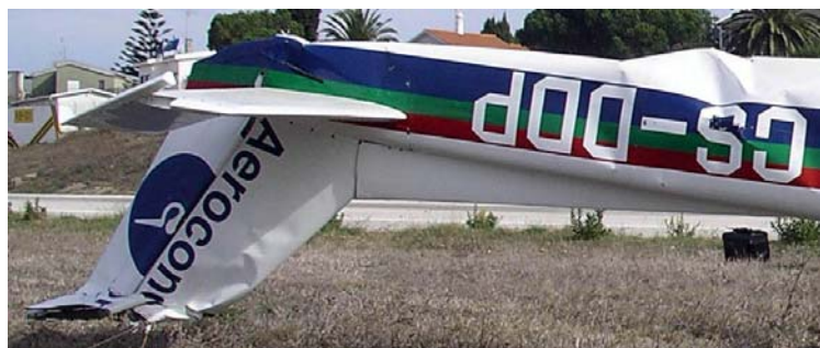
Fig. 11 – Empenagem vertical e parte da fuselagem danificadas.
