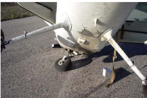
Figs. 5 e 6 – Deformação do trem de proa e das pás do hélice.
