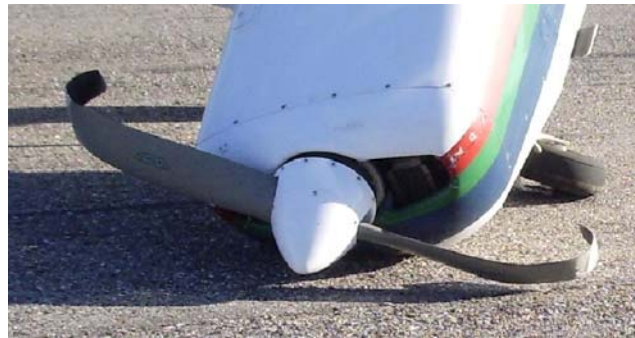
Figs. 5 e 6 – Deformação do trem de proa e das pás do hélice.
