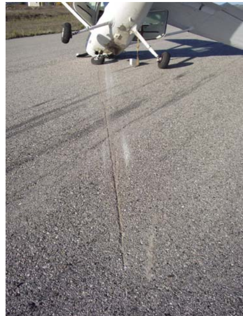
Figs. 3 e 4 – Local de imobilização e marcas de arrastamento da proa do CS-AUJ.
