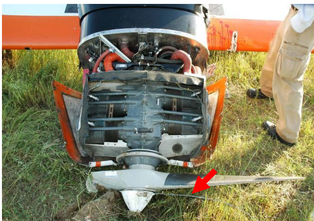
Fig. 22 – Evidência do arame farpado enredado no hélice.
