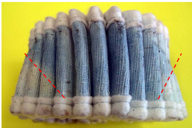
Fig. 16 – Filtro de ar evidenciando a mancha de contaminação por combustível.
