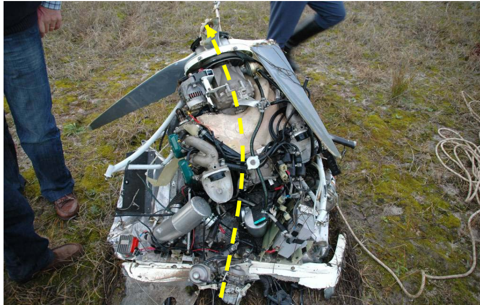
Fig. 22 – Desvio para a esquerda do motor por deformação do seu berço.
